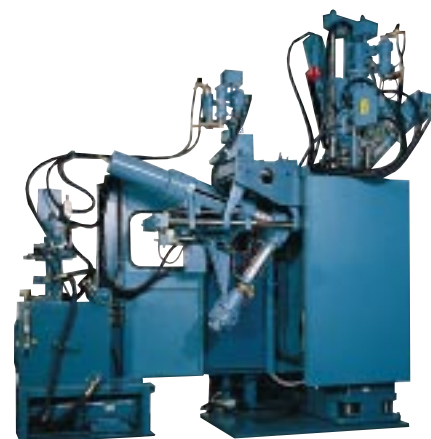
▲ Technique de bi-injection. Celle-ci permet l'injection séquentielle ou simultanée de deux matières. L'injection est alors réalisée par le haut pour une des matières et sur le côté, dans le plan de joint pour la seconde matière.
